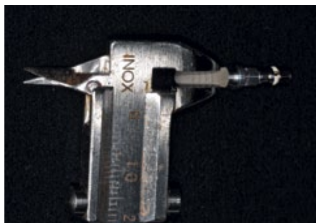
Abb. 2 Markierung der definierten Implantatoberfläche mit Schublehre
