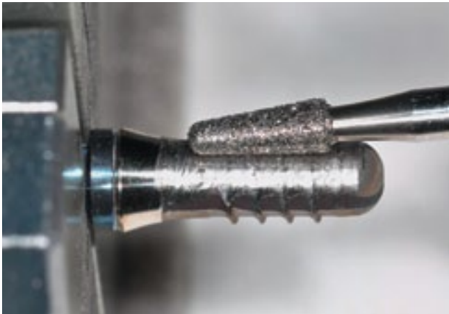
Abb. 3 Bearbeitung eines Implantates mit dem Referenzschleifkörper Nr. 11
